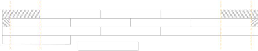
Abb. 12: Fortlaufende Verlegung mit Hilfslinien.
