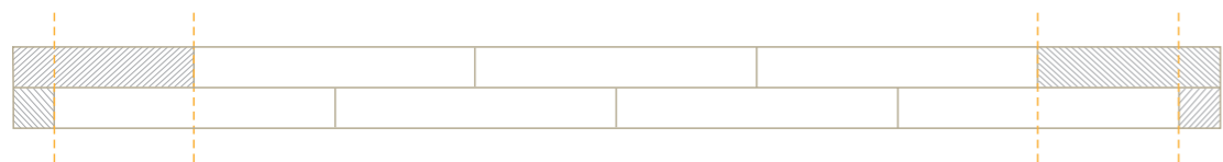
Figur 11: Nedlimning af udgangsrækker med referencelinjer samt tilpasningsstykker.
