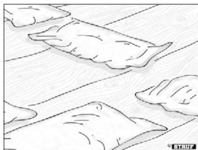
Die Bereiche entlang der Bodenkanten und die zuletzt verlegten Reihen sind besonders wichtig. Der Boden sollte erst nach dem Aushärten des Klebstoffs benutzt werden. Der Boden sollte erst mindestens 48 Stunden nach der vollflächigen Verklebung abgeschliffen und behandelt werden.
